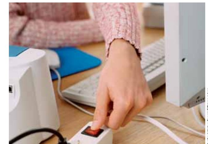
Steckdosenleiste mit Netzschalter
